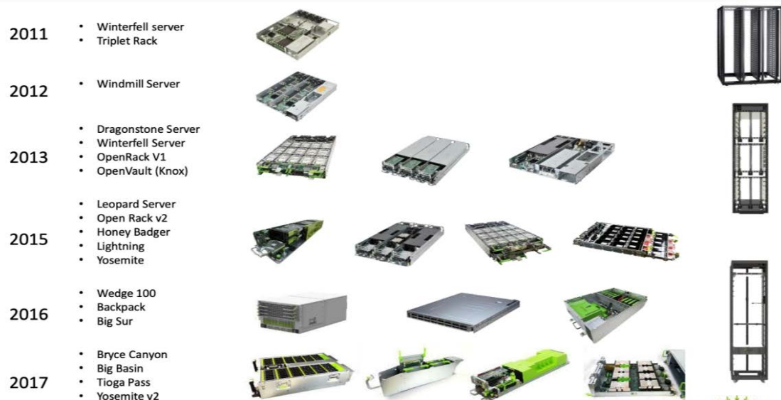
(例)OCPでのサーバ機器
