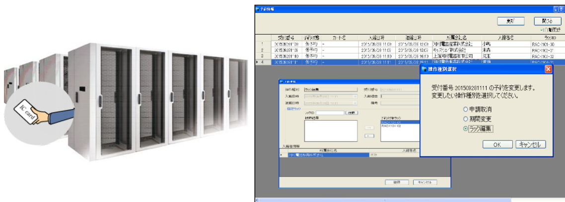
図 32 ICカードによるサーバーラックのシステム自動化の画面例
