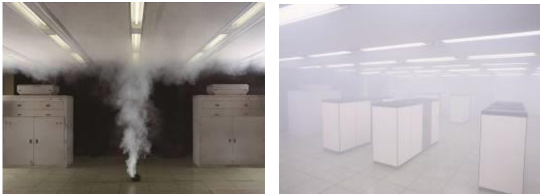
図 26 一般的なオフィス（左）とサーバー室（右）での煙の広がり方の違い
